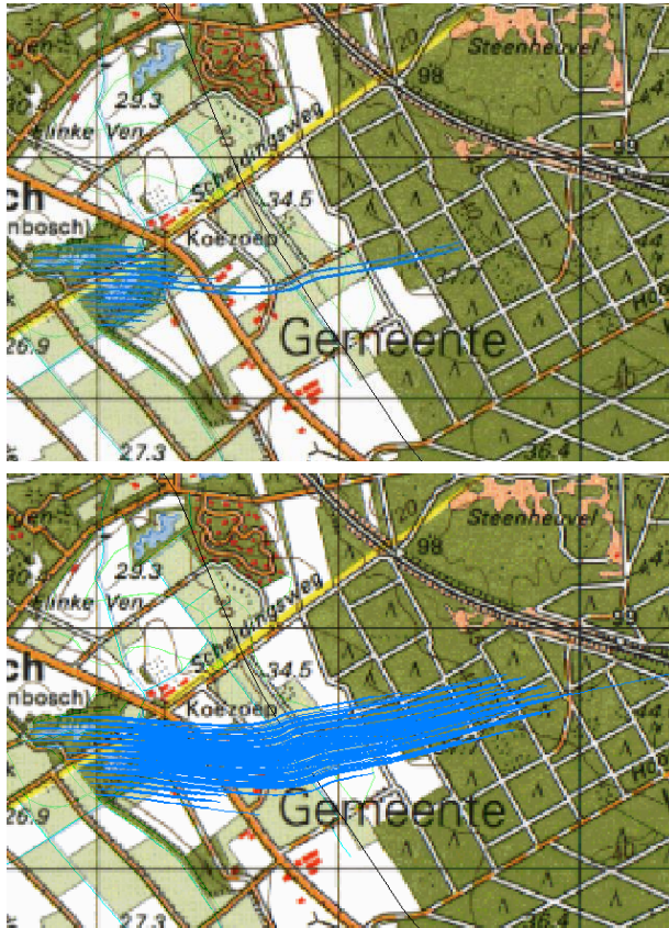
Figuur 3-10 Stroombanen met een looptijd van 5 jaar en 20 jaar bij de Turfkoelen (WRO, 2008a; 2011)
