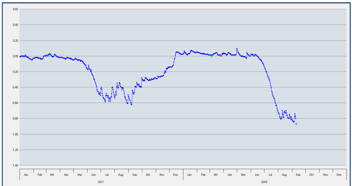
Figuur 3-9 Waterstand t.o.v. maaiveld in de Turfkoelen in 2017 en 2018. De ideale voorjaarsgrondwaterstanden liggen tussen 20 boven maaiveld en 80 beneden het maaiveld.
