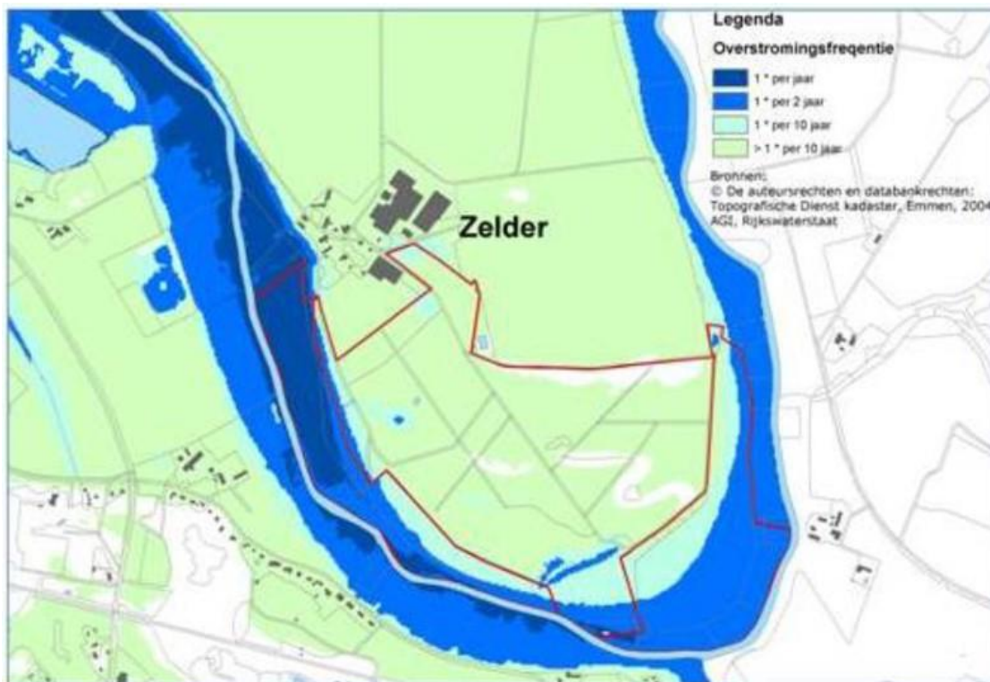
Figuur 6. Overstromingsfrequentie van de Niers (Ministerie van Verkeer en Waterstaat, 2008).
